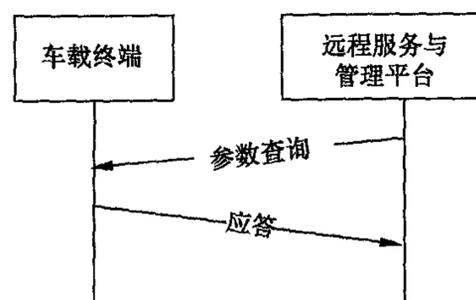
图 B.4 参数设置流程示意图
