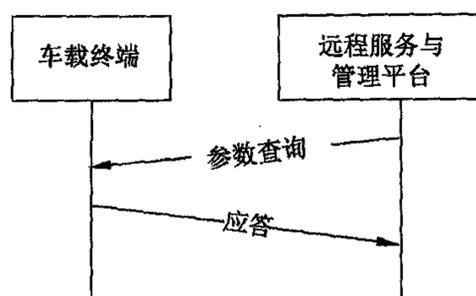
图 B.3 参数查询流程示意图
