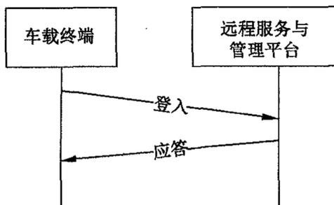
图 B.1 车辆登入流程示意图
