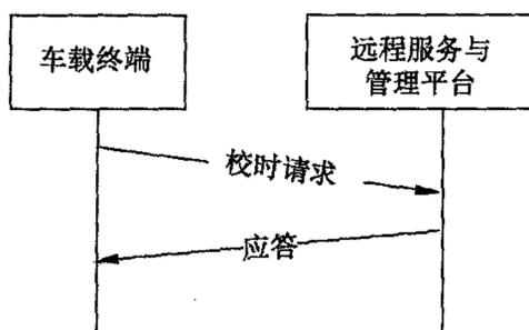
图 B.6 终端校时流程示意图
