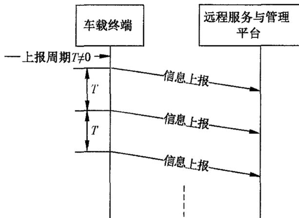
图 B.2 实时信息上报流程示意图
