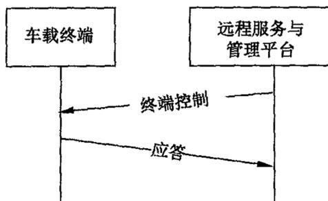
图 B.5 车载终端控制流程示意图
